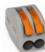
*Borne pour boîte de dérivation; Borne pour 2 conducteurs; avec leviers de manipulation; Température max. d'utilisation continue, 85 °C*
