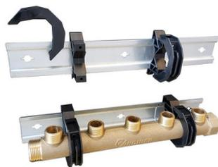
Compatible avec collecteurs 20x27 et 26x34 ( $\varnothing$  22 à 34 mm). Montage facile et rapide par clipsage des colliers. Vis fournies pour finaliser l'installation. Adaptable à toute longueur de collecteurs (2 à 8 piquages) en coulissant les colliers. Possibilité de positionner indépendamment les collecteurs. Colliers en plastiques isophoniques et diélectriques.
