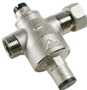
Réducteur à piston pour la protection d'un appareil isolé. Liquide compatible Eau Pression nominale PN25 Pression max. en amont 2500 KPa ? 25 bars Pression en aval réglable 50÷400 KPa (0,5÷4 bars), 50÷700 KPa (0,5÷7 bars) selon les modèles Pré-étalonnage d'usine 300 KPa (seulement modèles avec pression en aval réglable 0,5÷4 bar). Filetage UNI-EN-ISO 228 Température d'exercice max. 80 °C.
