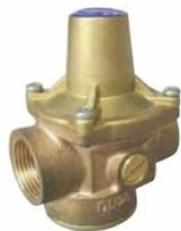
Normalisé NF EN 1567. Fonctionne en toutes positions. Pression amont maxi 16 bar. Pression aval réglable de 1 à 5,5 bar. Prérégulé d'usine à 3 bar. Débit 2000 l/h en 15/21, 2800 l/h en 20/27 pour une perte de charge de 1 bar. Bouchon 1/4" de chaque côté permettant la pose d'un manomètre. Corps bronze.
