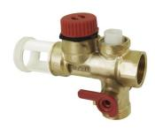
Taré à 7 bars. Il incorpore : Robinet de fermeture, Dispositif de purge ou vidange, Dispositif antiretour.
