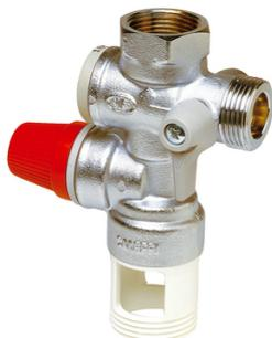
Protège les chauffe-eau jusqu'à une puissance de 10 kW. Corps chromé, vanne à sphère et clapet anti-retour en laiton. Pression de tarage de la soupape de sécurité: 7 bar. Agrée NF.
