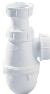
Siphon universel pour tout type de lavabo. Entrée en 1"1/4 réglable en hauteur. Sortie pour tube Ø 32. Garde d'eau 50 mm. Débit 43 L/mn (sous 120 mm d'eau)
