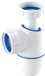
Le siphon pour évier Easyphon de Nicoll est en plastique blanc. Il dispose de joints co-injectés au corps de la bonde, pour une étanchéité immédiate. Hauteur minimum : 133 mm. Hauteur maximum : 192 mm. Filetage Gaz : 1"1/2. Garde d'eau : 50 mm.
