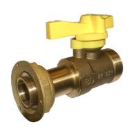
Pression maximale d?utilisation : 500 mbar. Filetage mâle et écrou prisonnier tournant femelle 6/20 à Joint Plat Compteur plombable. Pour compteur G4 (6 m3/h). Classe de température : - 20°C / + 60°C. Certifié NF ROB GAZ. Conforme NF EN 331. Pour compteur G4 (6 m3/h). Classe de température : - 20°C / + 60°C.
