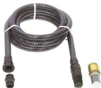
Aspiration pompe surface domestique. Clapet crépine laiton. Raccordement écrou prisonnier et joint plat 1 F. Tuyau souple armé de 7 m diamètre 22.
