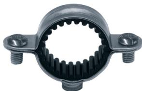
Pour le montage de tubes et tuyaux cuivre, acier, multicouche tout en réduisant les bruits issus du passage des fluides. S'utilise en association avec des pattes à vis, rosaces et rallonges avec un pas de 7 x 150.
