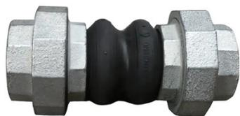
Compensateur de dilatation élastomère, avec soufflet EPDM, raccords union. Fonte galvanisée, renfort toile Nylon, PN16 pour réseaux d'adduction et de distribution d'eau.
