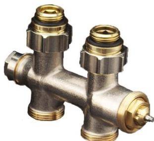
Corps en laiton nickelé, tige en acier inoxydable avec étanchéité par double joint torique. Installation possible quel que soit la position. Filetage mâle G 1/2 x eurocône G 3/4.
