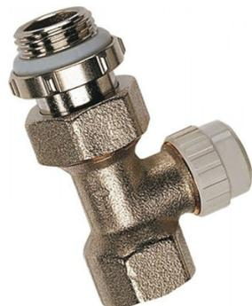
Té de réglage équerre en JET LINE. Raccord RFS. Corps en laiton nickelé. Capuchon en ABS. Pression maxi 10 bars.
