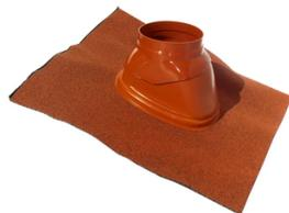
Le solin d'étanchéité est équipé d'une bavette 500x500 en Ubiflex, matériau malléable qui épouse parfaitement la forme des éléments de couverture. Sa rotule permet de régler précisément la pente. Bavette Ubiflex : matériau malléable Etanchéité parfaite au niveau de la sortie de toit Rotule intégrée pour réglage de la pente
