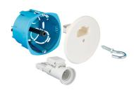
Boîte: Diamètre 67mm profondeur 50mm - Accepte gaine ICTA D16, D20 et D25, - Axe permettant de fixer un arrimage fileté type M6 à l'arrière de la boite - Piton d'arrimage du luminaire. Couvercle: Diamètre 88mm - Système de pré-maintien du couvercle sur l'axe - Accepte toutes les douilles DCL du marché - Connexions rapides avec repiquage
