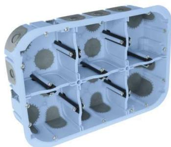
Profondeur 50mm. Entraxe 71 mm, montage vertical ou horizontal. Accepte gaine ICTA D16, D20 et D25, Cloisons de séparation des circuits. Tenue au fil incandescent : 850°C (Te: < 30s).
