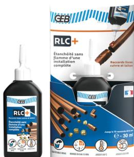
Résine anaérobie qui permet de réaliser l'étanchéité des accords lisses sur les canalisations en cuivre et laiton. Assemblage d'une installation complète sans utilisation de la flamme jusqu'à 70 raccords de diamètre 14. Temps de remise en eau : 15 minutes après l'installation du dernier raccord jusqu'à 30 bars. Température -20°C à +80°C. Conformité eau potable : Certifié WRAS.
