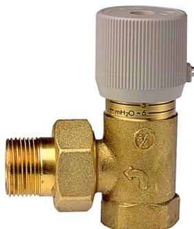
Corps laiton. Température maxi : 110°C. Pression maxi : 10 bar. Puissance maxi : 100 kW. Réglage : 1 à 6 mce. Diamètre raccord : 3/4" MF. Puissance installation : 46 kw / 40 000 kcal/h.
