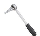
Clé de montage étagée 3/8" - 1/2" - 3/4" - 1" avec cliquet Ø 1/2" femelle. Destinée au montage des raccords à écrou prisonnier qui assurent la liaison entre le radiateur et son robinet de réglage. Clé courte pour intervention en endroits restreints, sur les écrous à ergots ainsi que sur les écrous à 6 pans intérieurs.
