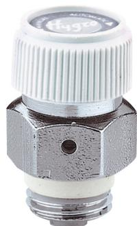
Purgeur à disque de fibre. Laiton chromé avec volant en Hostaform/verre. Etanchéité sur le filetage en Teflon spécial.
