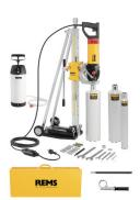
Carotteuse électrique. Réglage précis de la vitesse de rotation optimale. Maintien de la vitesse en charge. Carottage diamant béton armé jusqu?au Ø 122 (200) mm et maçonnerie Ø 250 mm. Vitesse de rotation optimale réglable en continu (700 à 2000 t/min).
