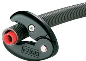
Coupe les gaines de protection des tubes PE ainsi que de la plupart des gaines électriques jusqu'au Ø 45 mm. Coupe la gaine sans "blesser" le tube dans la gaine. Lames en acier inoxydable très résistantes, démontables et interchangeables.
