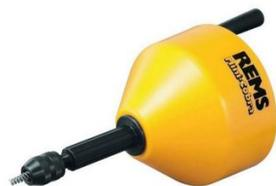
Appareil maniable, éprouvé, pour interventions rapides sur tubes bouchés dans cuisine, salle de bains, toilettes, etc. Pour tubes Ø 20?50 (75) mm. Pour spirales Ø 6, 8, 10 mm.
