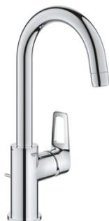
Taille L. Colour: Chromé. Monotrou sur plage. Levier de commande métallique. GROHE Long-Life cartouche en céramique 28 mm. Avec limiteur de température. GROHE Brilliance Longue Durée Brilliance éclatante année après année. GROHE Économie d'eau mousseur 5 l/min. Système d'installation rapide. Bec tube pivotant. Garniture de vidage matériau synthétique 1"1/4. Flexibles de raccordement souples.
