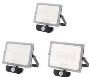
Projecteur LED pour éclairage extérieur, 3000K, 4000K ou 5000K au choix via un interrupteur à l'arrière du luminaire. Diffuseur en polycarbonate. Livré avec 0.50m de câble avec détecteur orientable IR 120°, zone de détection réglable max. 8m. Convertisseur non dimmable intégré dans l'appareil.
