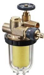
Robinet d'arrêt à fermeture rapide. Élément filtrant en tamis nickelé 100-50 m. Raccordement femelle 12x17 pour raccords de bourrage 6, 8, 10 ou 12 mm. Débit 500L/h. Livré sans raccords. Corps laiton.
