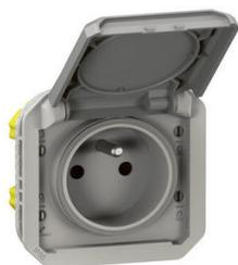
Prise de courant 2P+T 16A 250V - Connexion rapide sans outil avec repérage couleur. Produit à compléter soit avec un boîtier saillie, soit avec un support encastré. IP55 : protégé contre les poussières et les projections d'eau à la lance de toutes directions. IK08 : résistance à un choc de 5 joules.
