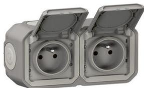
Prise de courant 2P+T 16A 250V - Connexion rapide sans outil avec repérage couleur. Produit complet, prêt à être installé en saillie. IP55 : protégé contre les poussières et les projections d'eau à la lance de toutes directions. IK07 : résistance à un choc de 2 joules.
