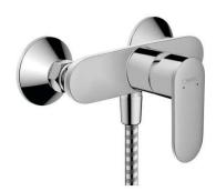
1 fonction. Débit maximal à 3 bars: 30 l/min. Débit de la douchette à 3 bars: 15,2 l/min. Cartouche céramique à 2 vitesses. Limiteur de température réglable. Clapet anti-retour. Avec silencieux. Convient au chauffe-eau instantané. E1, C2, A2, U3. Type de raccordement: raccords S. ACS 20 ACC NY 102 France, valide jusqu'au 23.06.2025. NF\_375-M1-23-1.
