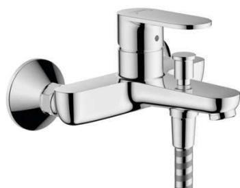
2 fonctions. Projection: 171 mm. Distance du centre: 150 mm  $\pm$  12 mm. Type de jet du mitigeur: jet normal. Débit maximal à 3 bars: 22,4 l/min. Débit du bec de baignoire à 3 bars: 22,4 l/min. Débit de la douchette à 3 bars: 15,9 l/min. Cartouche céramique à 2 vitesses. Limiteur de température réglable. Inverseur avec réinitialisation automatique. Avec silencieux. Convient au chauffe-eau instantané. Type de raccordement: raccords S.
