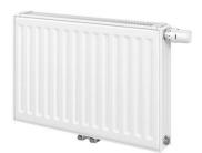
Couleur Standard : Blanc Sanitaire Ral 9016. Fixations : équipé d'étriers et livré avec des consoles. Raccordement : équipé de 6 orifices (4 x Ø15/21 portée plate femelle et 2 x en bas au centre Ø 20/27 porté conique mâle (entraxe 50 mm)). Livré complet avec consoles, bouchon purgeur et bouchon de vidange. Le radiateur acier T6 3010 à raccordement central bénéficie de la technologie innovante et du système breveté d'alimentation en forme de T intégré, nouveauté et avantages significatifs.
