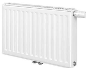
Couleur Standard : Blanc Sanitaire Ral 9016. Fixations : équipé d'étriers et livré avec des consoles. Raccordement : équipé de 6 orifices (4 x Ø15/21 portée plate femelle et 2 x en bas au centre Ø 20/27 porté conique mâle (entraxe 50 mm)). Livré complet avec consoles, bouchon purgeur et bouchon de vidange. Le radiateur acier T6 3010 à raccordement central bénéficie de la technologie innovante et du système breveté d'alimentation en forme de T intégré, nouveauté et avantages significatifs.
