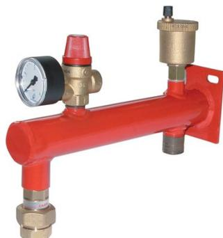
Potence murale pour pose de vase d'expansion jusqu'à 25 litres. Accessoires montés : un purgeur d'air R2, une soupape de sécurité NF, S15ZM, avec manomètre, un raccord ZR558, pour contrôle du vase sans vidange de l'installation.
