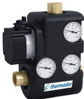
Kit complet permettant un recyclage vers le foyer tant que la température de consigne n'est pas atteinte. Livré avec 3 thermometres. Puissance max chaudière 65KW. Pression max 10bars. Débit max 2,8m<sup>3</sup>/H. Eau - Glycol max 50%
