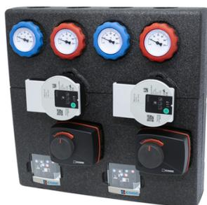
Unité compacte pour deux circuits de chauffage distincts. Un avec une alimentation directe et un avec une fonction de mélange. Équipé de deux pompes à haut rendement, d'une vanne progressive, d'un servomoteur, de vannes à billes avec thermomètres, d'un collecteur avec fonction de by-pass et d'une coque d'isolation. Particulièrement adapté aux pompes de chauffage et aux chaudières qui fonctionnent avec un chauffage au sol et/ou par radiateurs.
