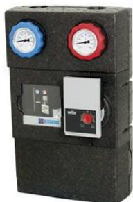
Conçus pour les applications nécessitant un transport de l'énergie des plus efficaces. Équipé de deux vannes d'arrêt avec thermomètres, d'un clapet anti-retour, d'une coque d'isolation de qualité supérieure et d'un circulateur à rendement élevé. Groupe équipé d'une pompe. De taille DN25 avec une pompe Wilo PARA 25/6. La pompe peut être paramétrée avec une vitesse constante, une pression variable ou une pression constante.
