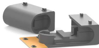
Les kits usine?s Rubaflex RBX sont conc?us pour le calorifugeage des pie?ces de forme complexe. Leurs reliefs inte?rieurs spe?cifiquement travaille?s permettent d?e?pouser parfaitement la pie?ce pour garantir : des pertes thermiques minimales, une mise en oeuvre rapide et une finition exemplaire.
