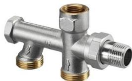
Distributeur monotube Uno G 3/4 M, avec douille en laiton. Diamètre nominal : DN 15. Pression différentielle max. : 1 bar. Pression de service max. : 10 bar. Température de service max. : 120 ° C.
