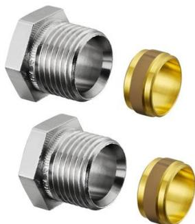
Raccord à serrage Ofix CEP par 2 pour filetage femelle G 1/2 M x 15 mm, pour tuyau de raccordement, à étanchéité métallique.
