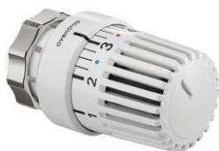
Bulbe liquide. Raccordement à griffes. Limitation et blocage. Position « zéro ». Pastille mémoire. Compatible malvoyants. Surface : blanche. Plage de réglage: 7-28 °C. Température de service max. : 120 °C. Se monte sans adaptateur sur les ensembles à robinetterie intégrée et les robinets thermostatiques avec fixation à griffes de la société Danfoss: Uni LDV pour la Série RAV (raccordement du thermostat Ø 34 mm), Uni LDVL pour la Série RAVL (raccordement du thermostat Ø 26 mm).
