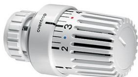
Bulbe liquide. Raccordement à griffes. Dispositif de limitation et blocage. Position « zéro ». Pastille mémoire. Compatible malvoyants. Se monte sans adaptateur sur la robinetterie intégrée des fabricants de radiateurs suivants: Agis, Arbonia, Brötje, Brugmann, Buderus, CICH, De'Longhi, Hudevad, Radel, Ribe/Rio, Schäfer, TERMO TECHNIK, Thor, Vogel &, Noot.
