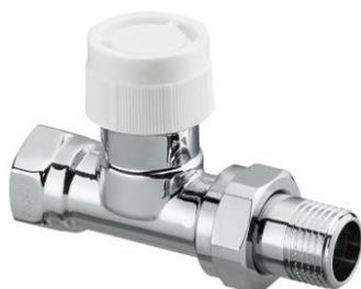
Modèle droit. Réglage rapide AV 9 avec 17 valeurs intermédiaires. Pour installations de chauffage bitubes. Laiton chromé. En période de service : entretien avec Demo-Bloc.
