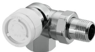
Modèle d'angle en raccordement à gauche. Réglage rapide AV 9 avec 17 valeurs intermédiaires. Pour installations de chauffage bitubes. Laiton chromé. En période de service : entretien avec Demo-Bloc.
