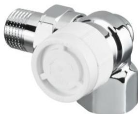
Modèle d'angle en raccordement à droite. Réglage rapide AV 9 avec 17 valeurs intermédiaires. Pour installations de chauffage bitubes. Laiton chromé. En période de service : entretien avec Demo-Bloc.
