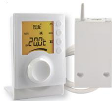
Thermostat d'ambiance Radio à molette pour chaudière ou PAC non réversible. Alimentation du boîtier d'ambiance : 2 piles LR03 (fournies). Alimentation du récepteur : 230 V. Longueur du câble du récepteur : 2 m. Sortie contact sec : 5 A. Plage de réglage de 5° à 30°C. Base de temps de régulation réglable de 15 min à 1 h.
