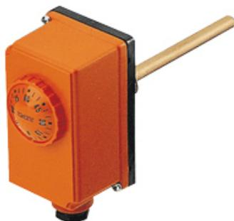
Raccord 1/2". Plage de réglage de 0 à 86°C. T° maxi du boîtier 90/10°C. Plongeur 97 mm. Aquastat + limiteur à réarmement manuel. Limiteur 90/110.
