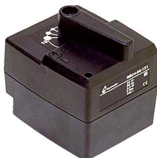
Servomoteur électrique 3 points pour vannes thermomix taraudées. Angle de rotation 90°C. Poids 400g / 500g suivant couple moteur. Température ambiante 0°C ? 50°C. Conformité CE.
