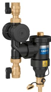
Pose sur conduites verticales, horizontales, ou à 45°. L'accès au filtre est bi-directionnel. Vannes d'arrêt à sphère. Vanne de purge orientable. Anneau magnétique amovible. Purge d'air manuelle, possibilité d'introduction d'additifs dans le circuit. Plage de température : 0 / 90 °C. Pression maxi. d'exercice : 3 bar. Fluides : eau, eau glycolée (30 % maxi.)
