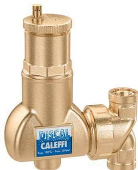
Corps laiton avec joint EPDM - Séparation de bulles par grille interne. Pression max de fonctionnement : 10 bar. Température de fonctionnement : 0 à 110°C. Glycol taux max : 50%.
